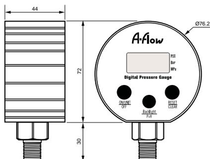
Диаметр корпуса 76.2 мм
