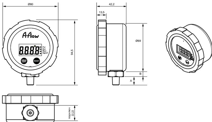
Диаметр корпуса 80 мм
