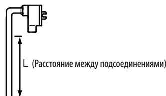
Уровнемер серии L-M. Установка сбоку
