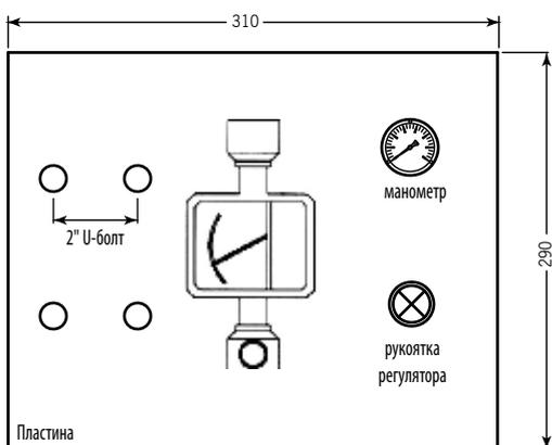
**Тип F. Металлический расходомер – две линии**
