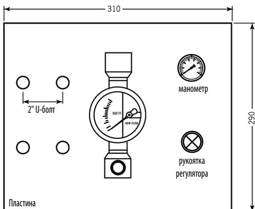
**Тип H. Металлический расходомер – две линии**
