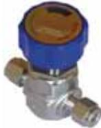
**DV** – Мембранная арматура. Вместо вентилей и шаровых кранов с сальниковым уплотнением штока используются мембранные клапаны. Данная опция рекомендуется для применений, в которых предъявляются особые требования к чистоте газа, и в исполнении рампы для коррозионно и химически-активных газов. Только для рампы серии GSB
