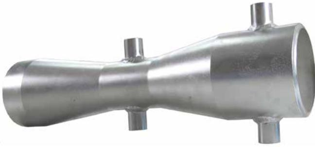
Труба Вентури представляет из себя трубу с коническими сужениями посередине. В суженной части трубы скорость потока возрастает, а давление падает. Патрубки отбора давления находятся на входной и в суженной частях.
